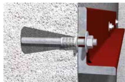
Détail : forage à dépouille arrière dans le béton cellulaire avec FIS V pour une capacité de charge maximale
