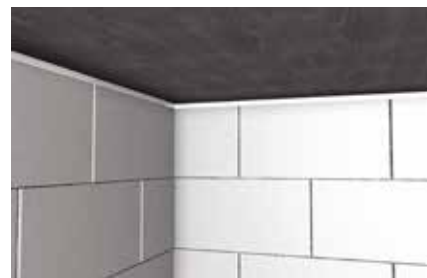
Joint de construction entre voile et dalle
