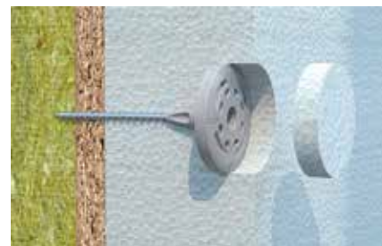
Fixation de panneaux de polystyrène sur panneaux d'OSB
