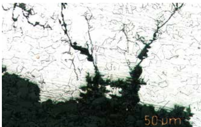
Exemple de fissure de contrainte transcrystalline liée à la corrosion sur de l'acier inoxydable 1.4401 avec une concentration en chlorure élevée.
