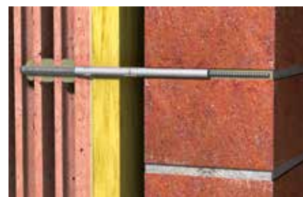
Détail : réparation de mur de parement
